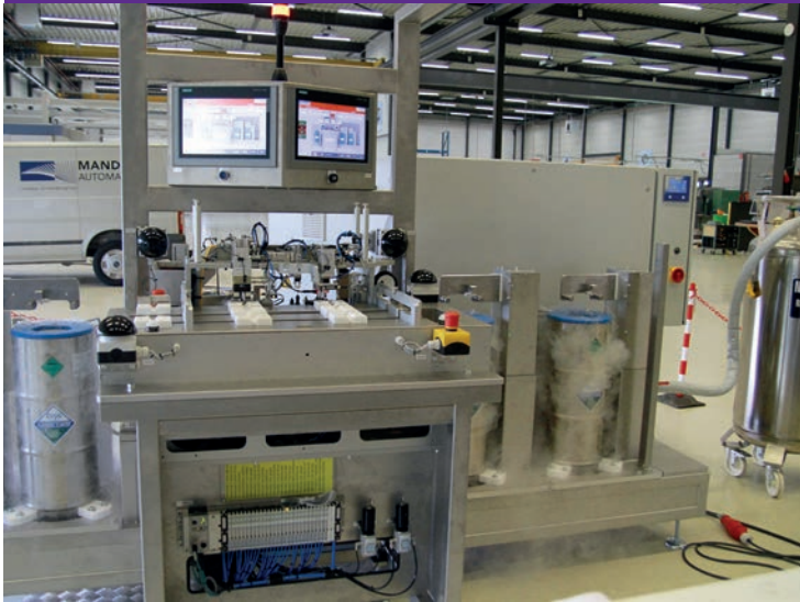
Overzicht van de recipping machine met de bijbehorende stikstoffaciliteiten. De machine is vanwege de testfase nog deels open; bij aflevering is alles netjes afgeschermd.
